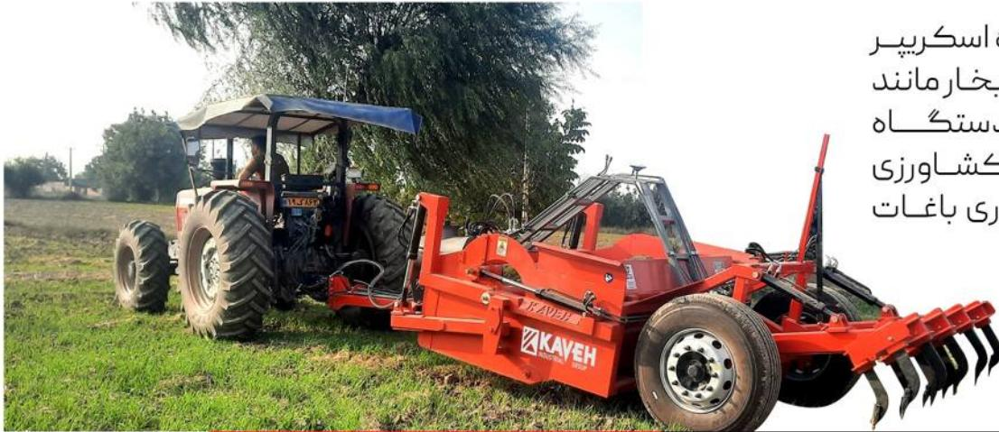
گروه صنعتی کاوه تولید کننده اسکریپر مناسب برای تراکتورهای ۱۱۰ اسب بخار مانند فرگوسن ۳۹۹ میباشد. از این دستگاه علاوه بر تسطیح دقیق اراضی کشاورزی میتوان در تسطیح و خاک برداری باغات مانند باغات پسته استفاده کرد.
